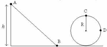
La altura de la rampa es de 50 m, la bolita una vez superada la rampa, a unos pocos metros se encuentra con un looping circular de radio 10 m. Calcular la energía cinética, potencial y mecánica y en los puntos, A, B, C y D. En el punto C calcular la fuerza centrífuga de la pelota.
